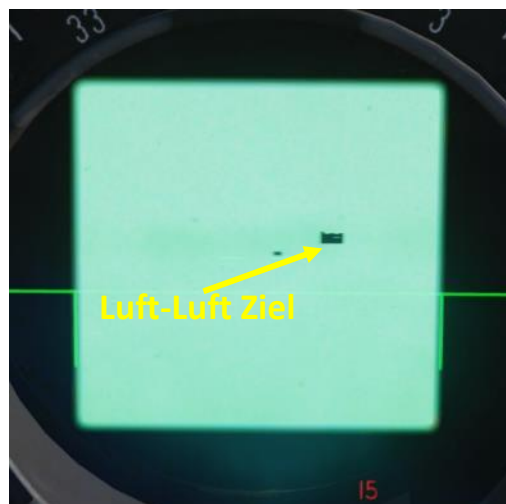
Radarbild Modus A2, Schmal Scann Modus B-Scope
