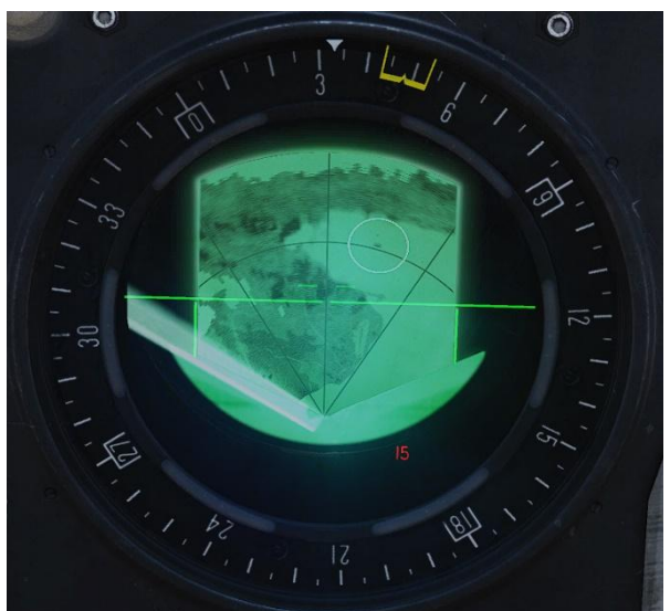
Radartaste TV drücken, Angriffspunkt wurde aktualisiert.
