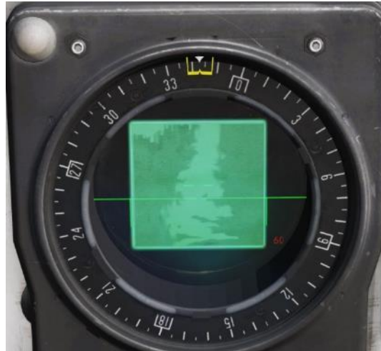
Radarbild Modus A2, Schmal Scann Modus B-Scope
