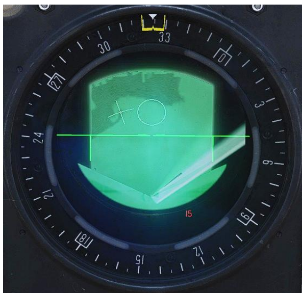
Mittels Radarstick Fadenkreuz verschieben
