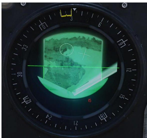
Fadenkreuz auf Schiff ausrichten
