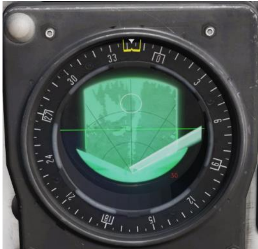
Radarbild Modus A1, Weit Scann Modus PPI
