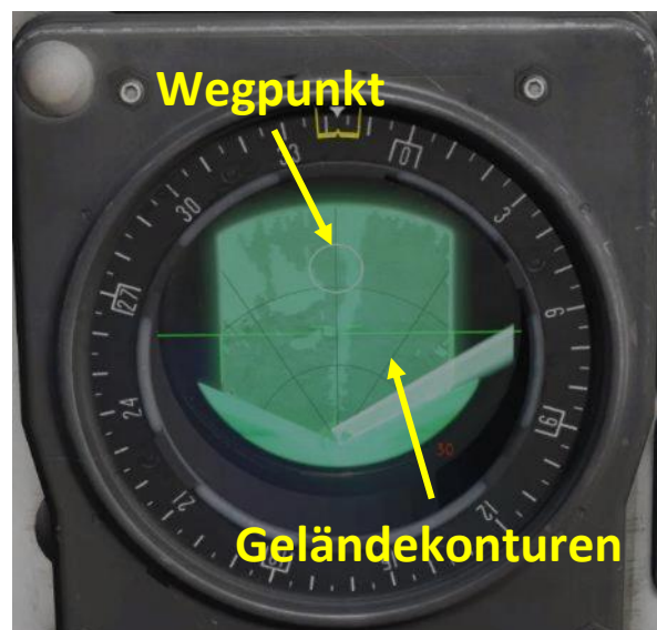
Radarbild über Gelände
